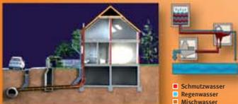
Im **Mischsystem** wird Regen- und Schmutzwasser gemeinsam einem Kanal der Kläranlage zugeführt.
