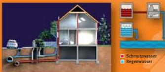
Im **Trennsystem** werden Regen- und Schmutzwasser in getrennten Kanälen abgeleitet, und zwar das Schmutzwasser zur Kläranlage und das Regenwasser in ein nahe liegendes Gewässer.
